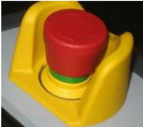
Fig. 2: Dispositivo di arresto di emergenza con protezione contro l'attivazione o il danneggiamento involontario
