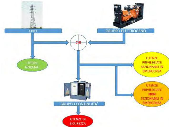
Nota: L'operatore "OR" indica che l'alimentazione nel nodo indicato può essere fornita in alternativa o da Enel oppure da Gruppo elettrogeno.
