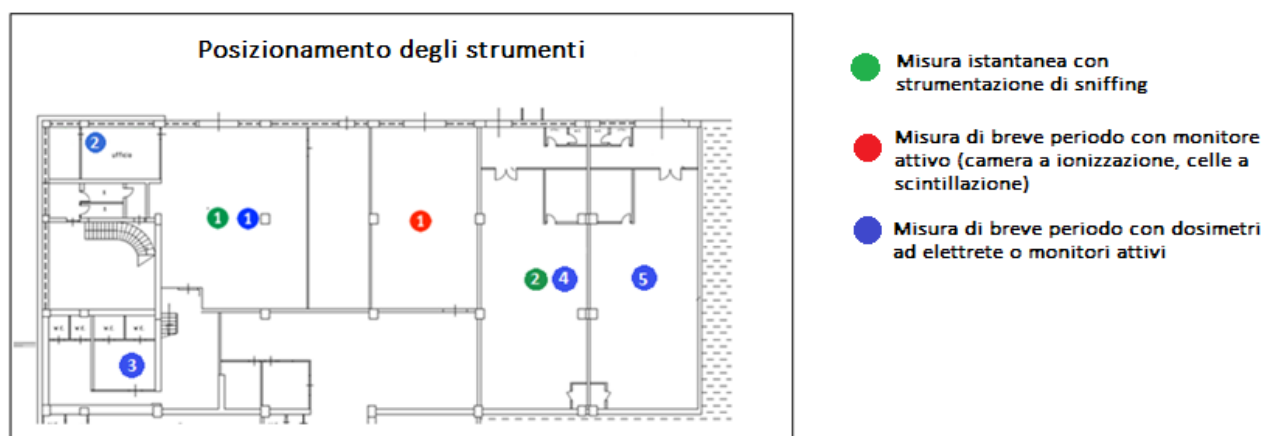
Fig.1 Posizione indicativa della strumentazione attiva e passiva su più locali sottoposti ad indagine.
