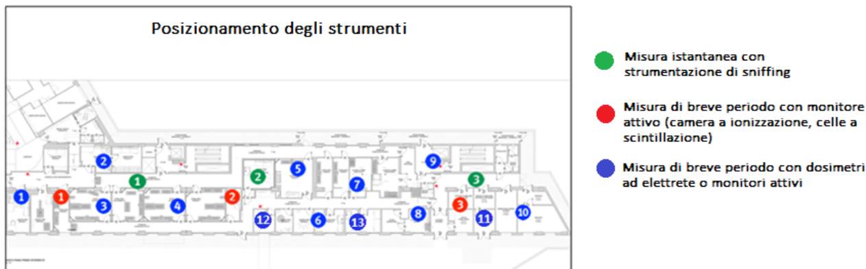
Fig.2 Posizione indicativa della strumentazione attiva e passiva su più locali sottoposti ad indagine. Dimensioni medio grandi
